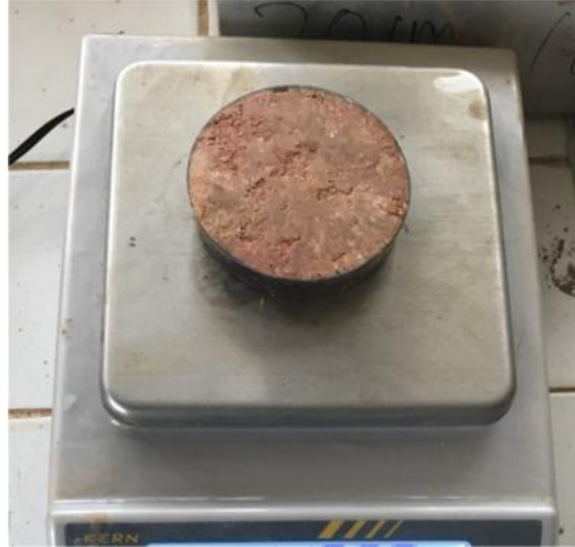
Gambar 10. Pengujian Berat Volume.
