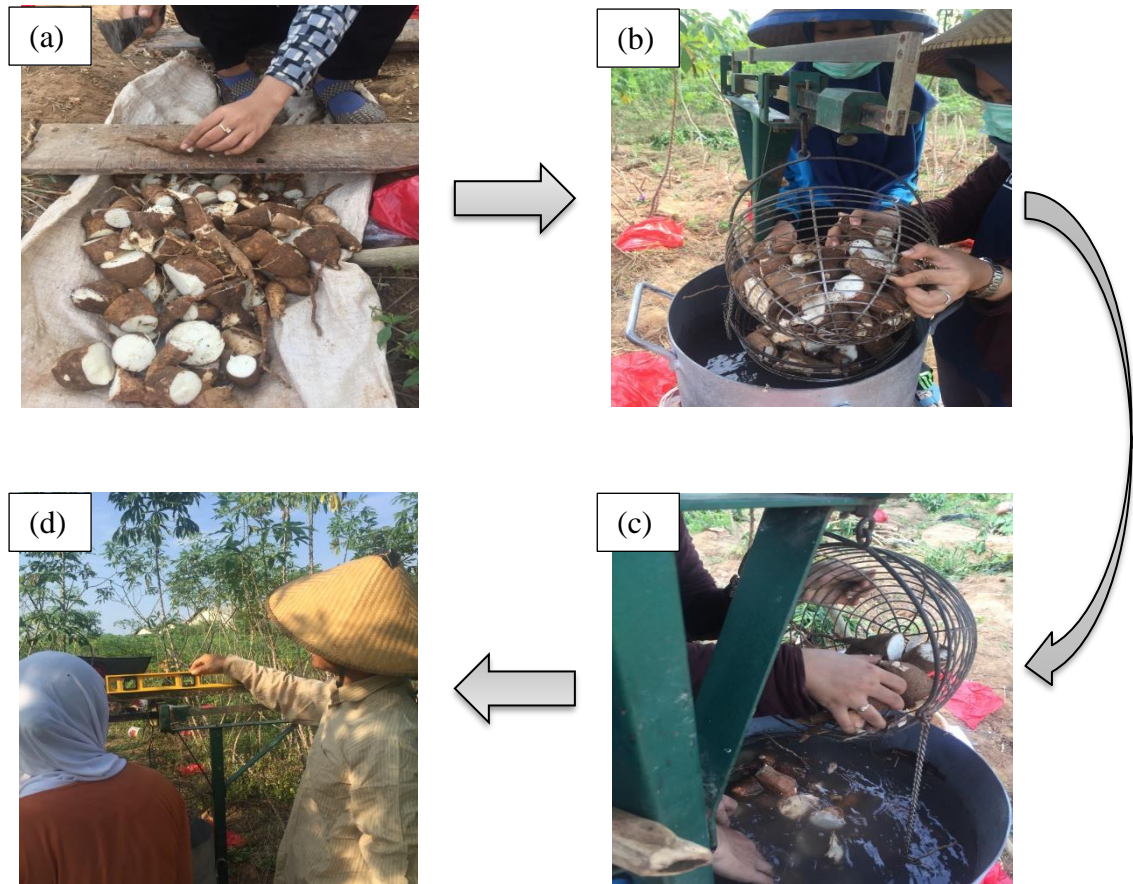
Gambar 5. Cara pengukuran kadar pati menggunakan Thai Sang Metric co. Ltd
