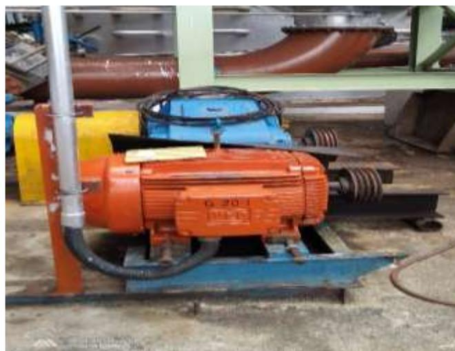
Gambar 2.10 Motor induksi 3 Fasa
