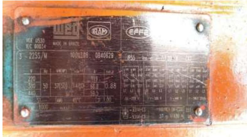
Gambar 2.11 Spesifikasi Motor Induksi 3 Fasa
