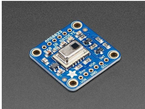
Gambar 1. Kamera termal Adafruit AMG8833 [10].
