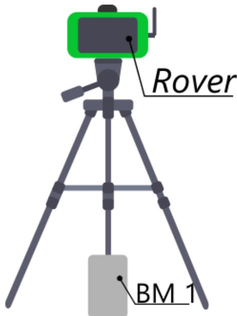
**Gambar 3.5** Ilustrasi Pengukuran Koodinat Posisi BM dengan *Receiver* GNSS Mandiri
