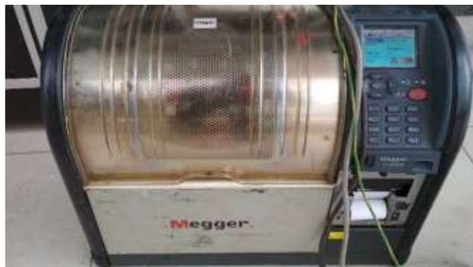
Gambar 3. 4 Alat uji tegangan tembus
