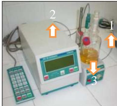
Gambar 3. 2 Alat uji kadar air
