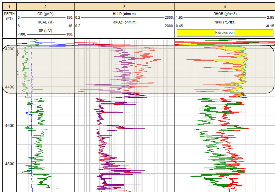
Gambar 21. Tampilan log yang mengandung zona prospek hidrokarbon pada sumur PRO3
