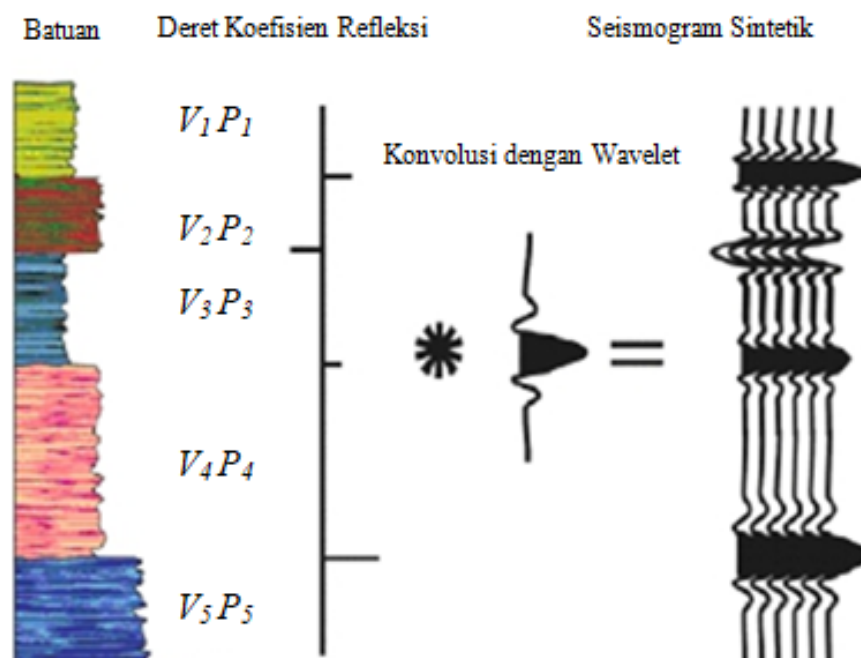
Gambar 11. Sintetik seismogram yang didapat dengan mengkonvolusikan koefisien refleksi dengan wavelet (Sukmono, 1999).
