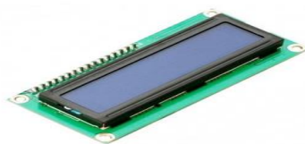
Gambar 2.15 Bentuk Fisik LCD 16x2.
