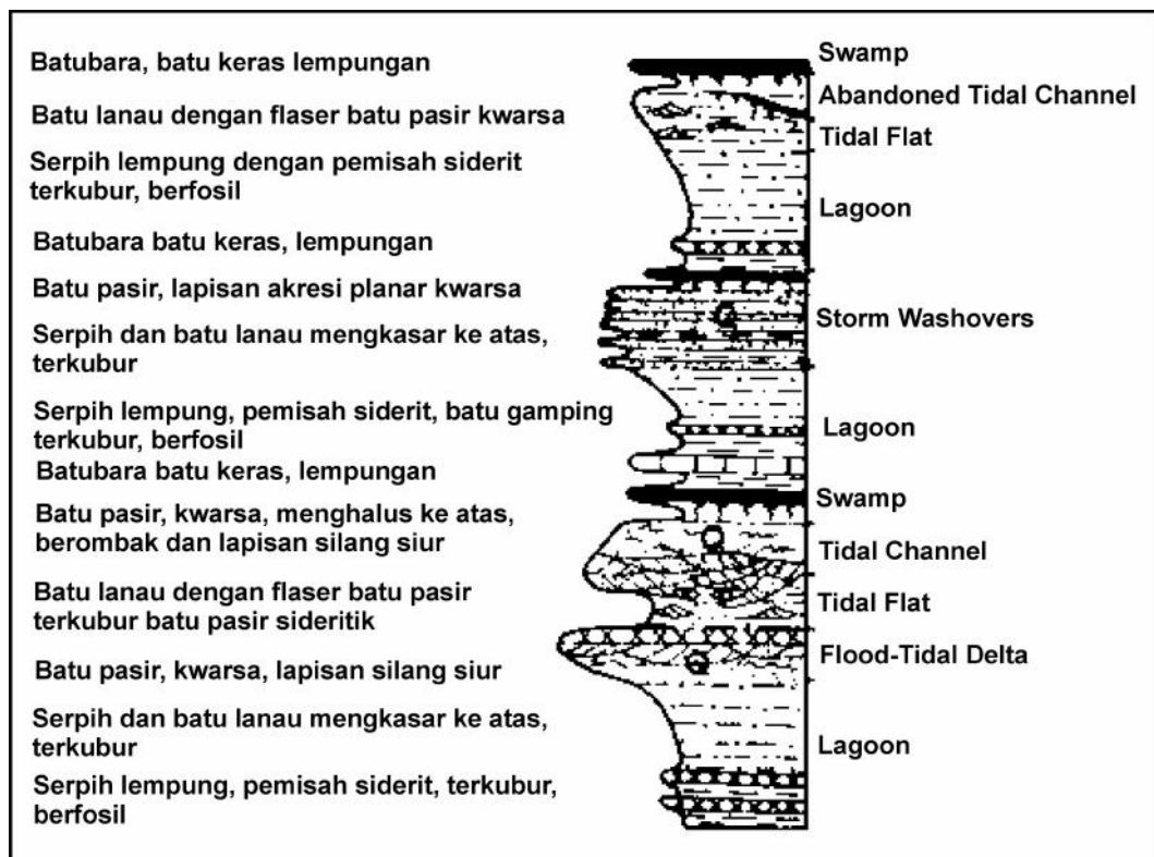
Gambar 19. Penampang Lingkungan Pengendapan pada bagian Back Barrier (Modifikasi dari Horne, 1978)
