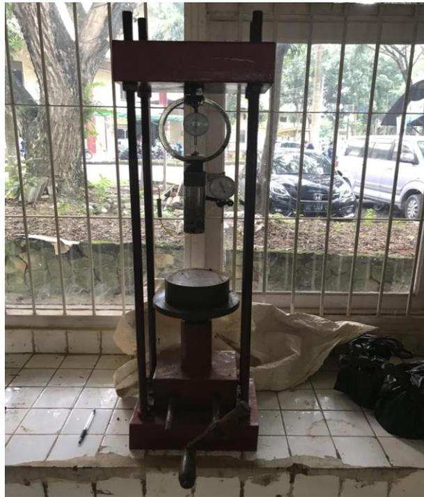
Gambar 4. Alat Uji Penetrasi CBR Laboratorium
