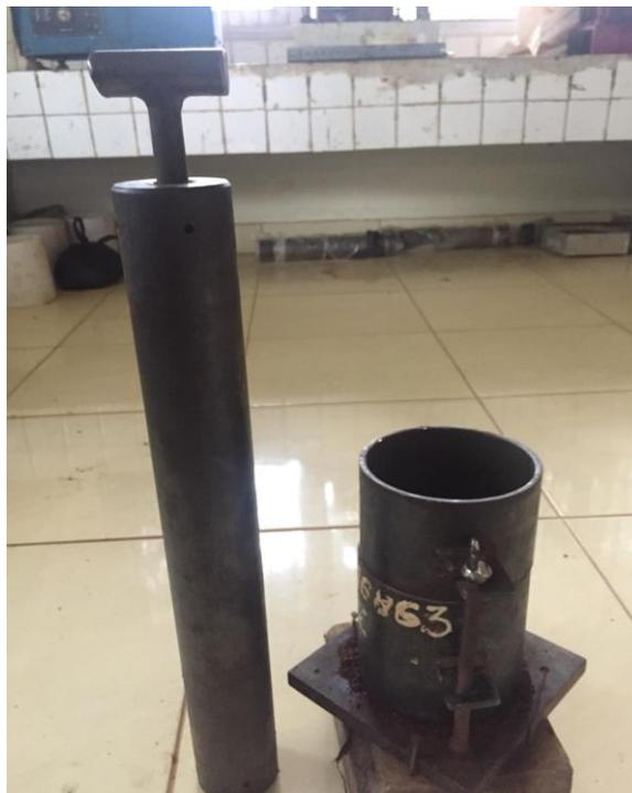
Gambar 3. Mold dan *Hammer* Uji CBR Laboratorium
