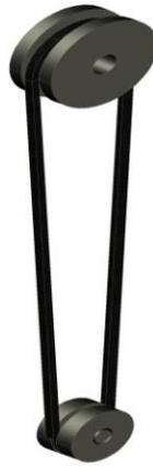
Gambar 8. Pulley dan V-belt
