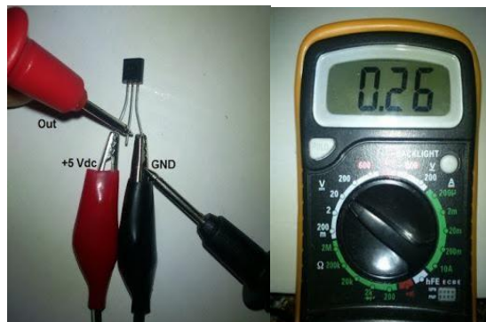
Gambar 4. Cara simple menggunakan sensor LM35 (Syam, 2013)
