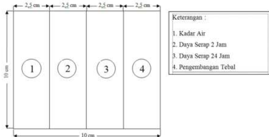
Gambar 6. Spesifikasi pemotongan papan sebelum pengujian
