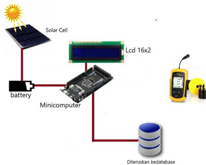
Gambar 3. 4 Merupakan rancangan Sistem Perangkat Buoy
