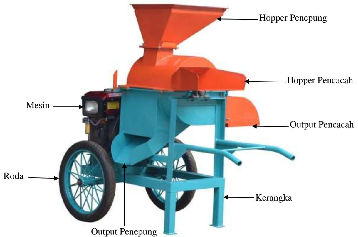
Gambar 1. Mesin pencacah (*Chopper*) seresah biomassa Tipe Multiguna
