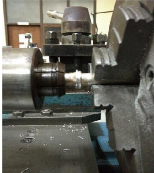
Gambar 29. Proses penyatuan material magnesium AZ31 setelah mesin dihentikan.
