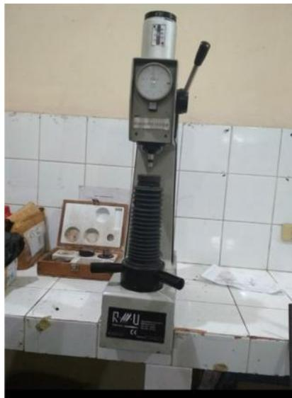
Gambar 3.2 Mesin Uji Kekerasan Rockwell
