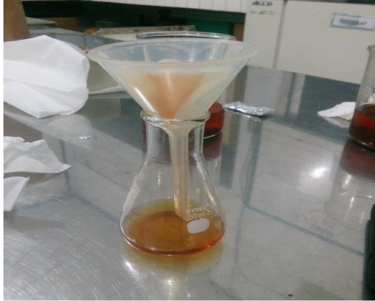
Gambar 10. Penyaringan menggunakan kertas saring (dokumen pribadi, 2018).
