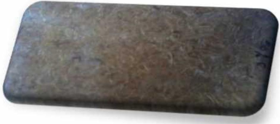
Gambar 2.1 Komposit polimer dengan serat batang pisang (Khotimah dkk,2014).
