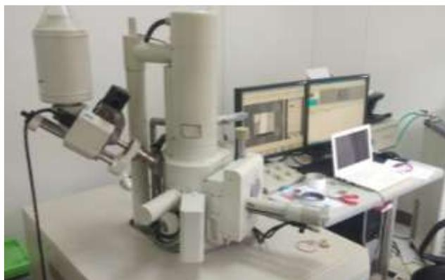
Gambar 26. Alat Uji SEM-EDX
