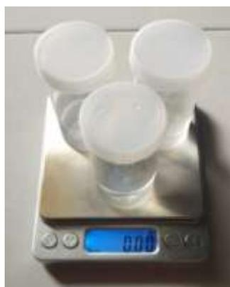
Gambar 23. Alat Uji Densitas dan Porositas
