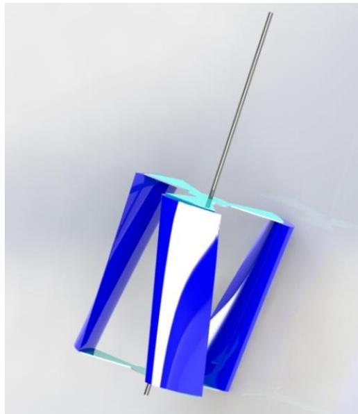
Gambar 27 Model turbin helik yang akan digunakan pada saluran irigasi Way Tebu.
