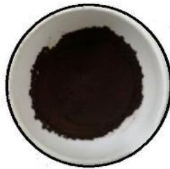
Gambar 8. Nanokatalis setelah dikalsinasi dan digerus dengan mortar agate
