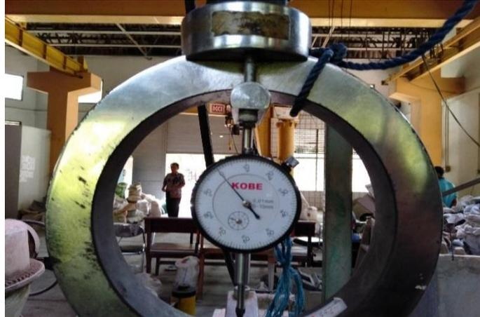
Gambar 4.15 Pemasangan *proving ring*.
