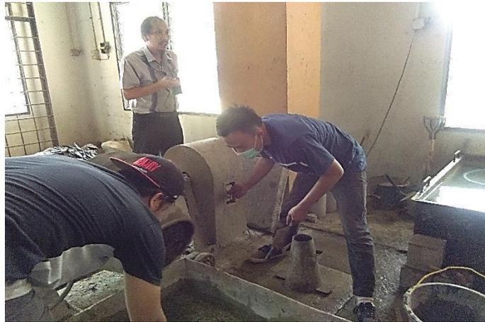
Gambar 4.5 Pencampuran agregat.
