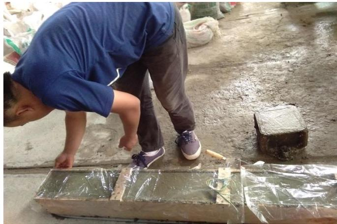
Gambar 4.9 Penutupan beton menggunakan plastik.
