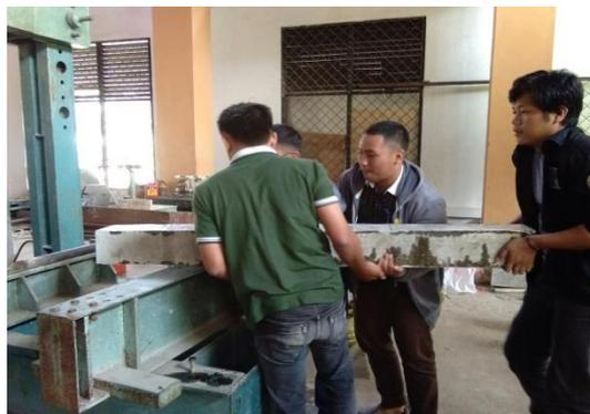
Gambar 4.14 Peletakan balok ke tumpuan.
