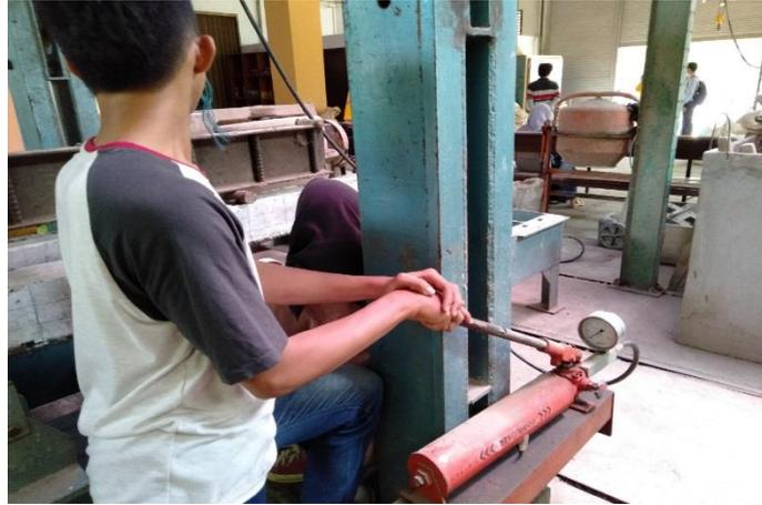
Gambar 4.17 Pompa hidraulik.
