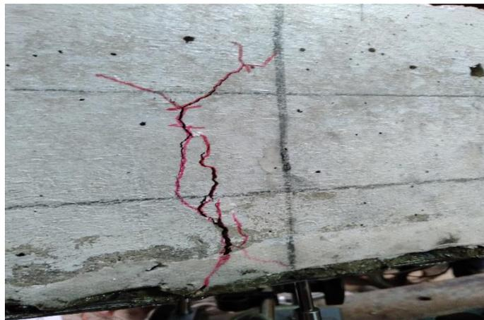
Gambar 4.22 Retak pada balok.
