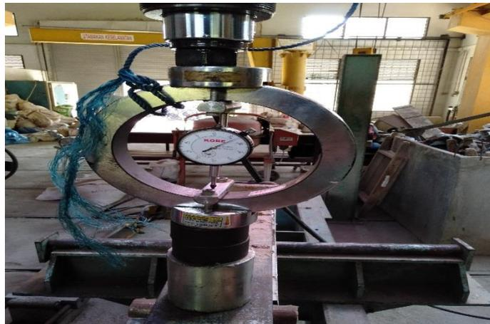
Gambar 4.20 Bacaan beban pada *proving ring*.
