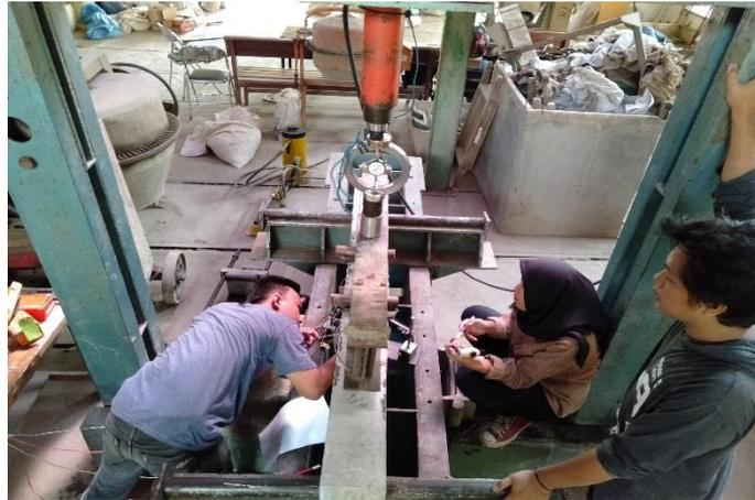
Gambar 4.21 Pembacaan besaran retak dengan *microcrack*.
