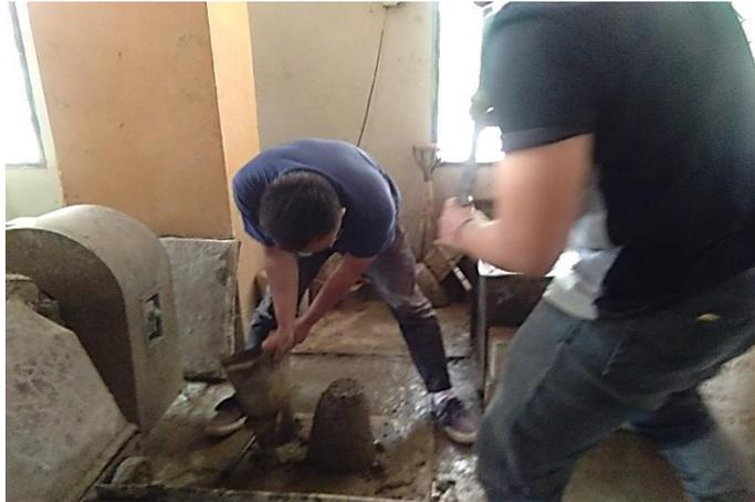
Gambar 4.6 Pengukuran *slump*.
