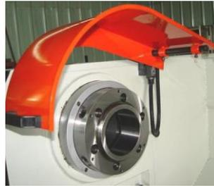
**Gambar 2.10** *Spindle* utama mesin bubut (Pandiangan, 2013)
