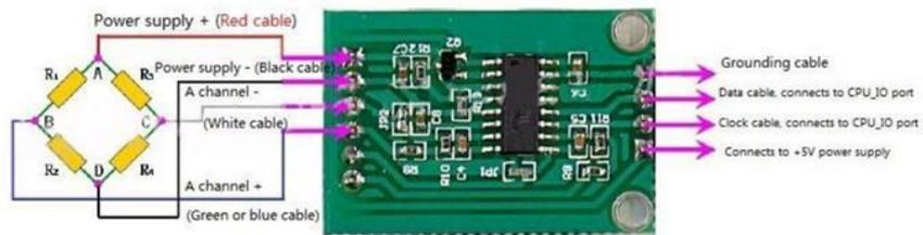
**Gambar 2.19** Sambungan sensor *load cell* dengan modul HX711
