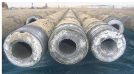
Gambar 1. Endapan kerak kalsium karbonat dalam pipa (Wang et al. , 2015).
