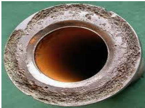
Gambar 3. Korosi celah pada sambungan pipa (Cramer, 2003)
