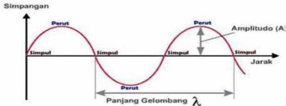
Gambar 6. Gerakan Gelombang Cahaya Elektromagnetik (Kristianingrum, 2014).
