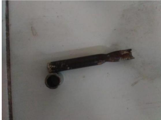
Gambar 18. Cetakan filter pelet
