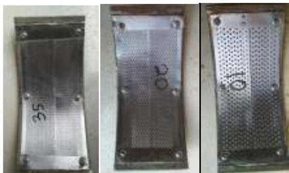
Gambar 3.2. Saringan yang digunakan untuk pengujian
