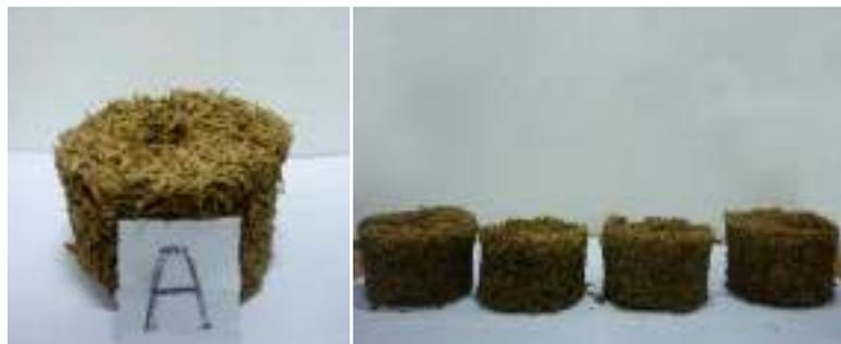
Gambar 2.8. Contoh briket yang terbuat dari sekam padi
