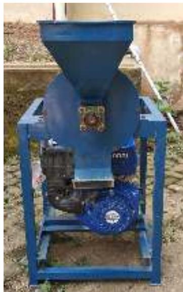
Gambar 3.1. Mesin penggiling sekam padi penggerak poros *horizontal*
