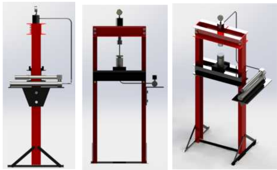
Gambar 22. Desain Mesin Tekan Briket
