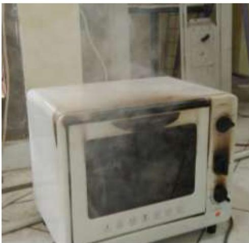
Gambar 22. Proses pengarangan sekam padi menggunakan *oven* listrik
