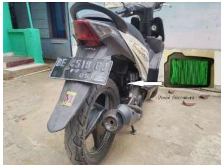
Gambar 28. Posisi *filter* udara
