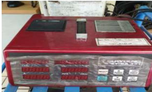
Gambar 7. Alat uji emisi gas buang
