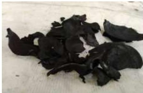
Gambar 21. Arang tempurung kelapa dikeluarkan dari drum pembakaran
