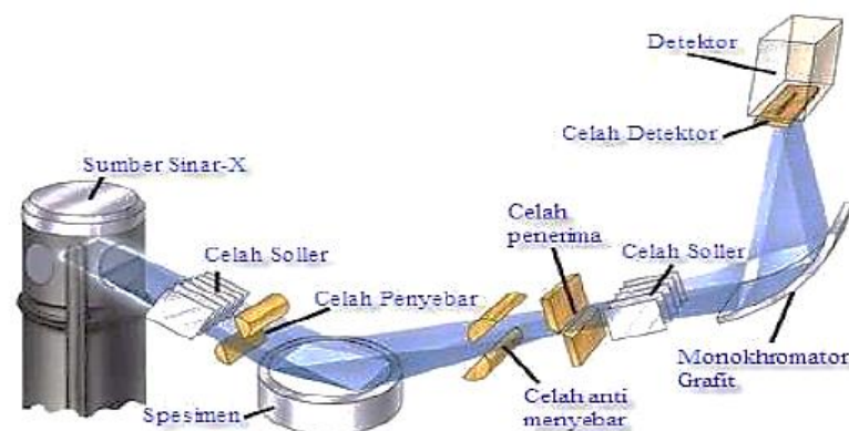
Gambar 4. Skema alat XRD.
