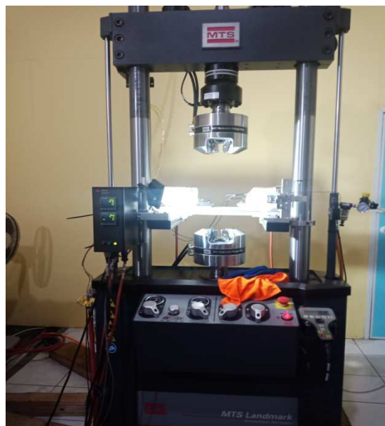
Gambar 2.6. Perangkat uji kuat tekan.
