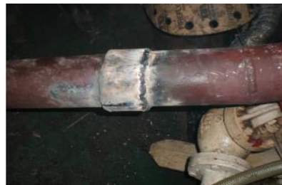
Gambar 7. Korosi retak tegangan (Sumber: Priyotomo, 2008).
