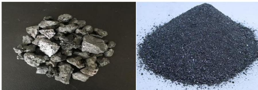
**Gambar 1.** Slag (kiri) dan *Copper slag* (kanan)
