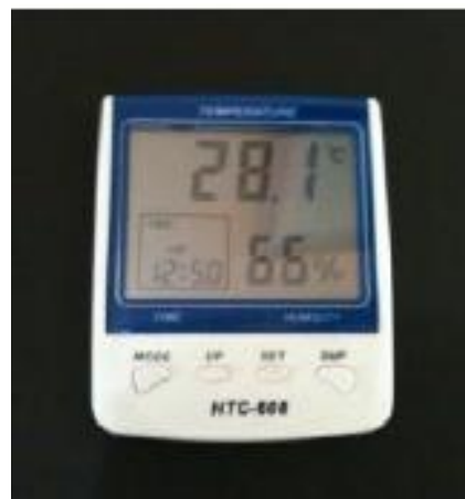
Gambar 1. Digital thermo-hygro meter (dikutip dari Shafiyah, 2010:7)
