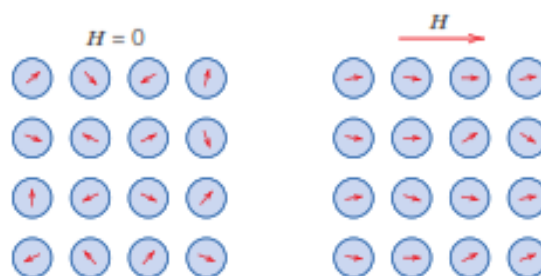
Gambar 16. Ilustrasi momen magnetik pada bahan paramagnetik sebelum dan sesudah diberi medan magnet luar (Calister, 2007)
