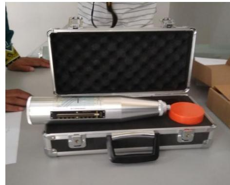
Gambar 4. *Hammer Test* untuk uji kuat tekan beton.
