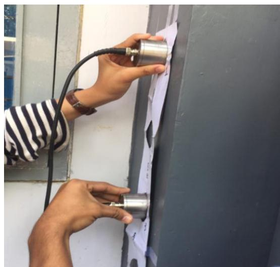
Gambar 14. Pengujian *Ultrasonic Pulse Velocity* pada Kolom.
