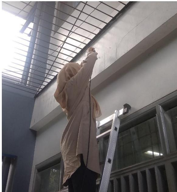
Gambar 13. Pengujian *Ultrasonic Pulse Velocity* pada Balok.
