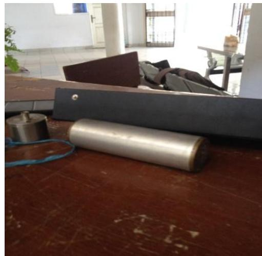
Gambar 7. Alat Kalibrasi UPV.
