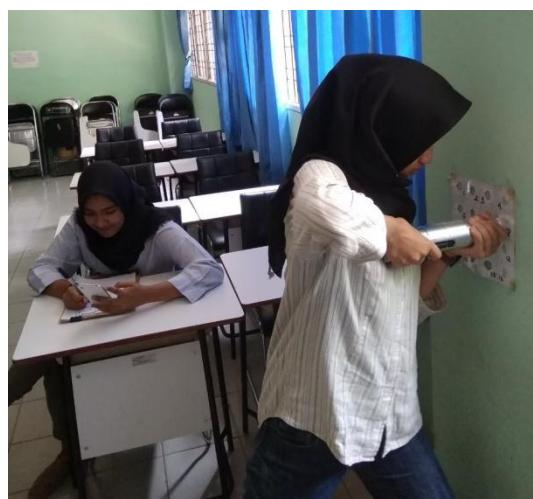
Gambar 12. Pengujian Hammer Test pada Kolom.
