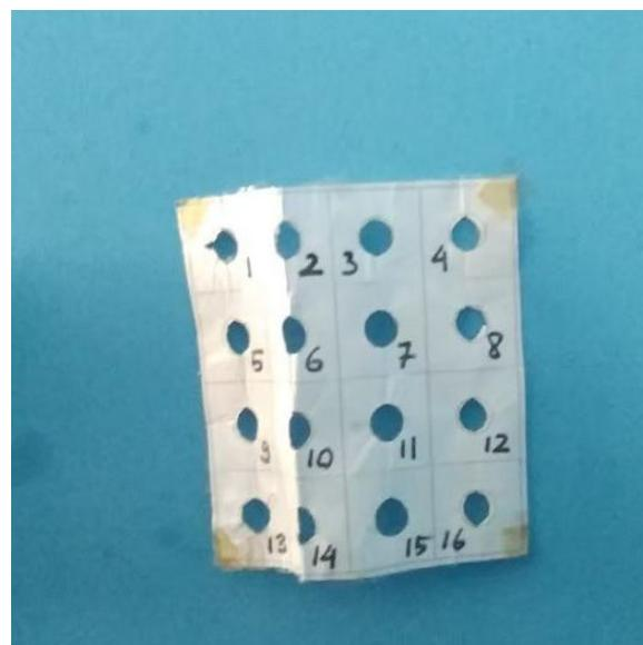
Gambar 4. Kertas Titik Pengambilan *Hammer Test*.
