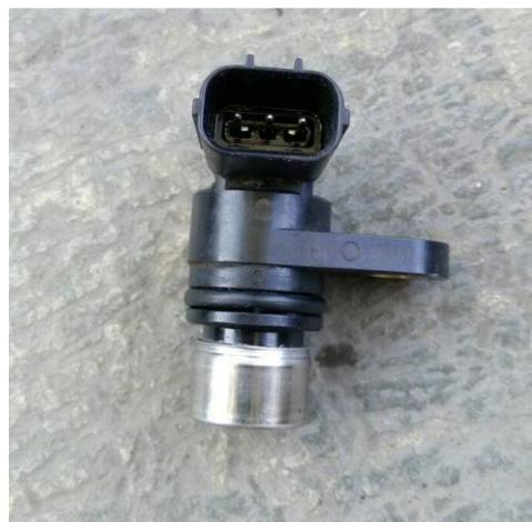
Gambar 2.1 Sensor kecepatan motor Honda Vario 125 esp
