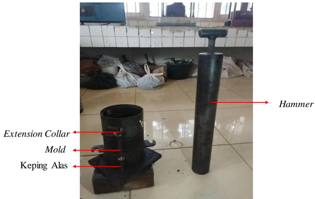
Gambar 1. Alat Uji Pemadatan Standar.
