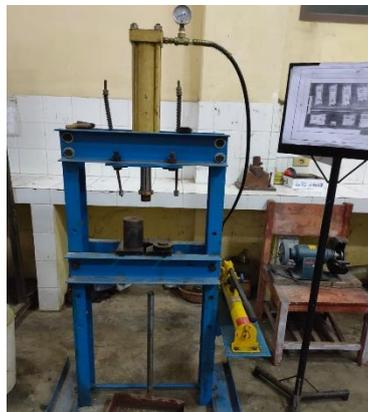
Gambar 3.1. Alat *press* hidrolik tekan kapasitas 8 ton
