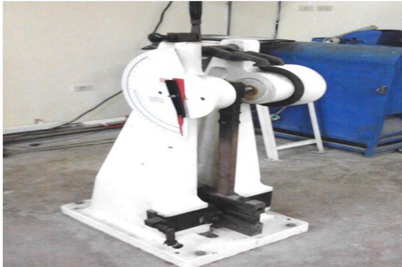
Gambar 3.8 mesin uji impak
