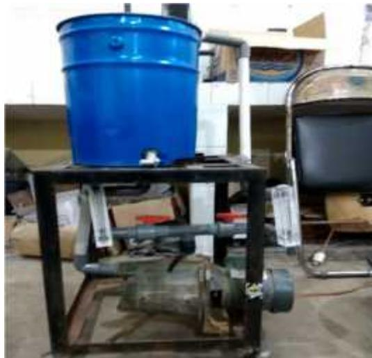
Gambar 6. Alat Instalansi *Quenching* Media Yang Disirkulasikan
