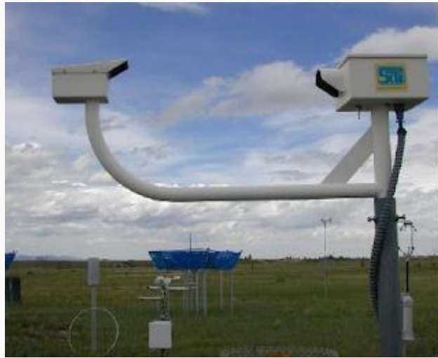
Gambar 6. Alat penakar hujan tipe optical . (Sumber : Hasyimzoem, 2019)
