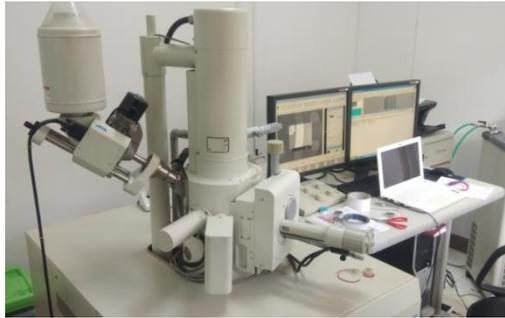
Gambar 22. Alat Uji Struktur Mikro SEM-EDX
