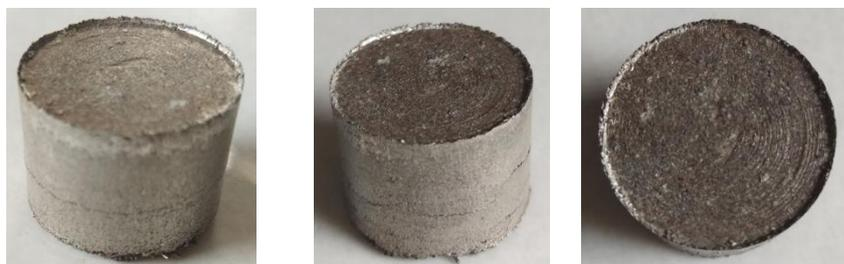
Gambar 29. Spesimen awal kompaksi sebelum diberikan sintering
