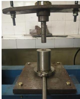
Gambar 28. Perangkat alat kompaksi
