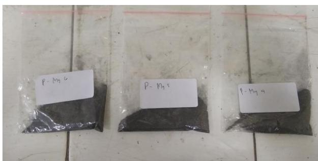
Gambar 27. campuran serbuk magnesium dan titanium
