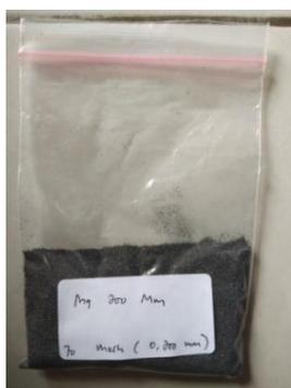
Gambar 25. Serbuk Magnesium dengan Ukuran 200  $\mu\text{m}$
