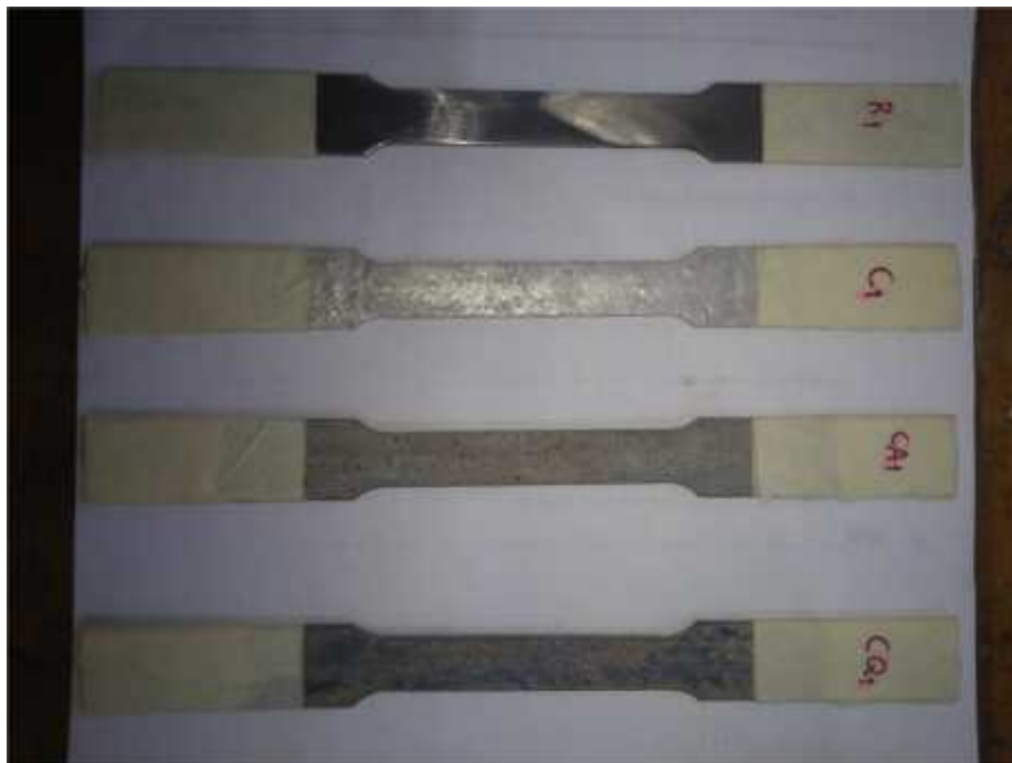
Gambar. 14. Spesimen Uji Tarik Standar ASTM E8.
