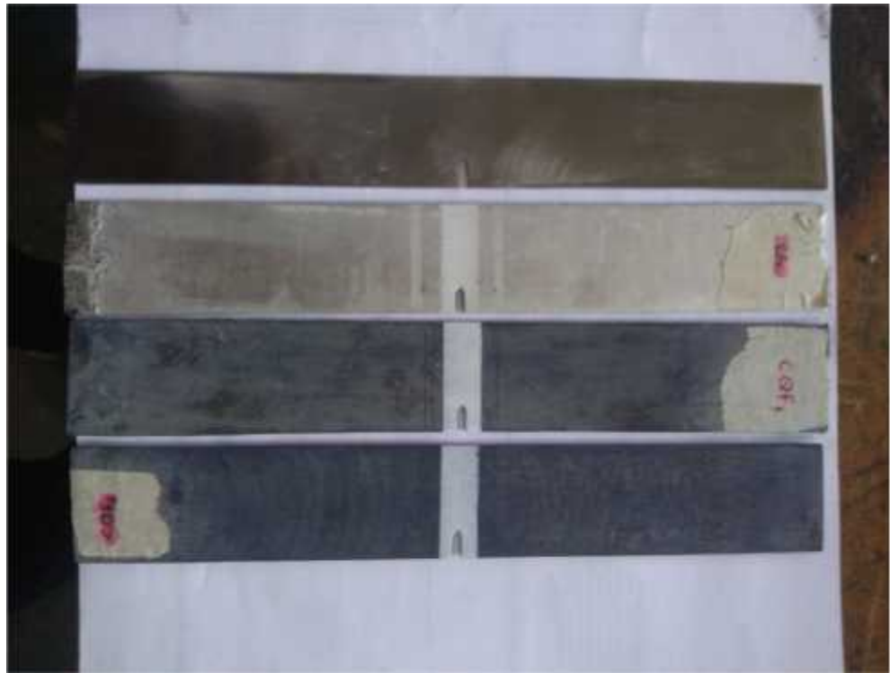
Gambar 15. Bentuk dan ukuran spesimen uji fatik ASTM E647
