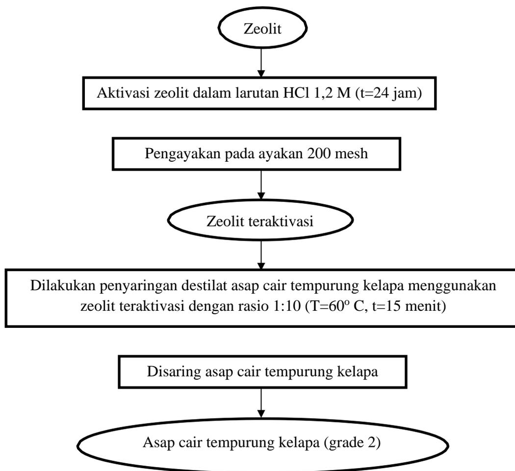
Gambar 4. Diagram alir proses pemurnian asap cair tempurung kelapa dengan zeolit teraktivasi
