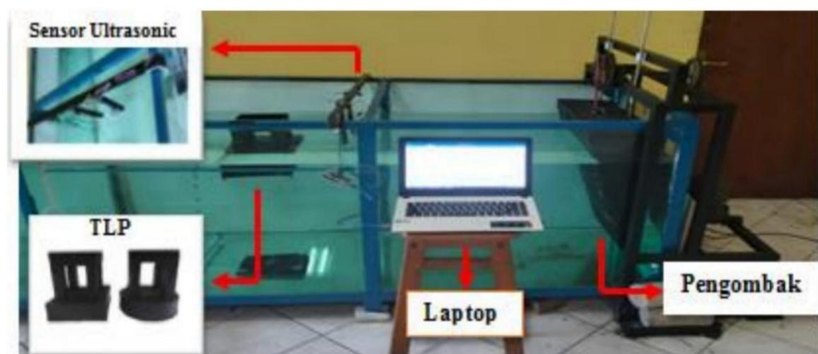
Gambar 21. Konfigurasi alat uji yang dipakai
