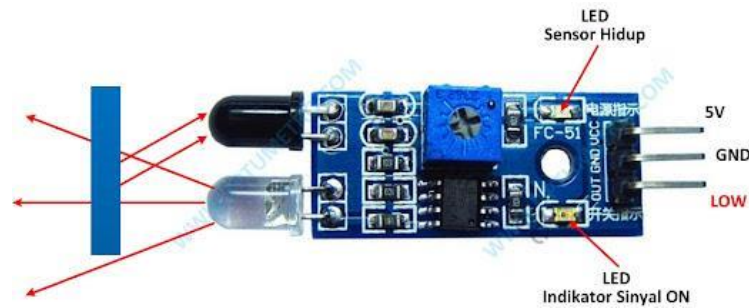
Gambar 2.2. Cara Kerja Modul Inframerah
