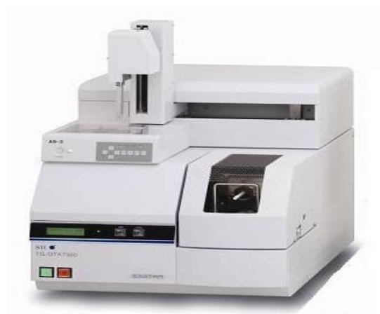
Gambar 10. Alat Differential Thermal Analysis/Thermogravimetric Analysis (TG/DTA) seri 7000 dengan Autosample (Laboratorium Biopolimer Unila).
